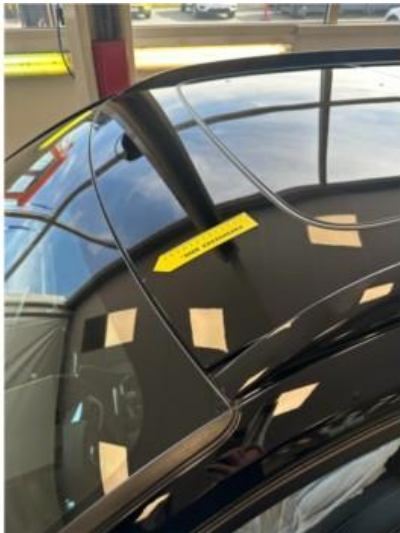
1.3 Steinsprut i forkant tak. Lakeres forenklet
