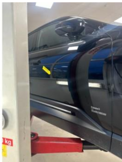
1.1 Ripe i dør høyre foran. Dempes med rubbing og polering
