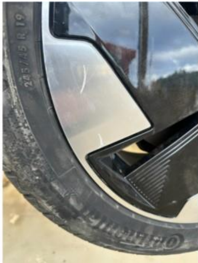
1.1 Ett par riper i en vinterfelg
