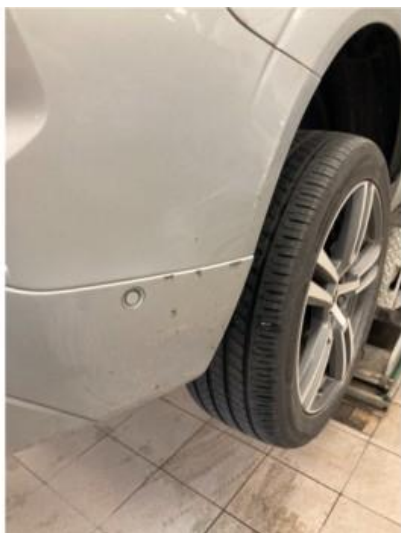
1.1 Noen riper/hakk i fanger bak. Lakkeres forenklet
