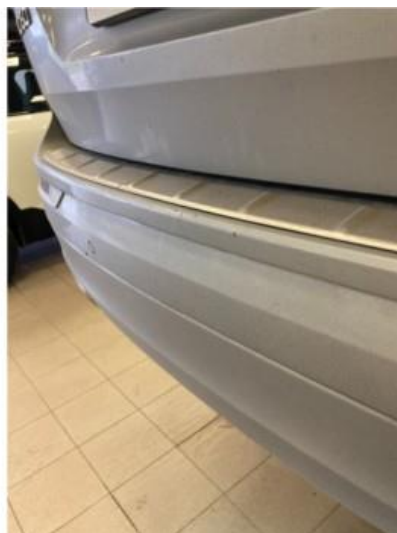
1.1 Noen riper/hakk i fanger bak. Lakkeres forenklet
