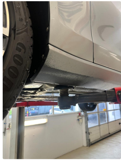
1.3 Noe slitt lakk i kanal begge sider
