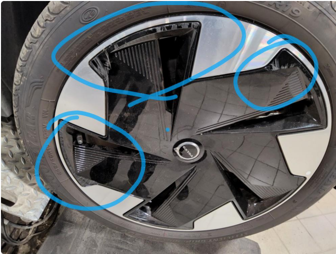
1.2 Hjul kapsel skadet
