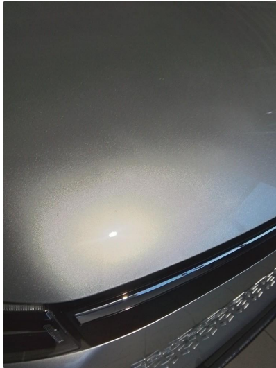
1.1 Liten stensprut lagt i lakk
