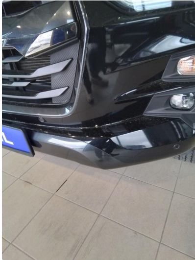
1.1 Små stensprut. Lagt I lakk
