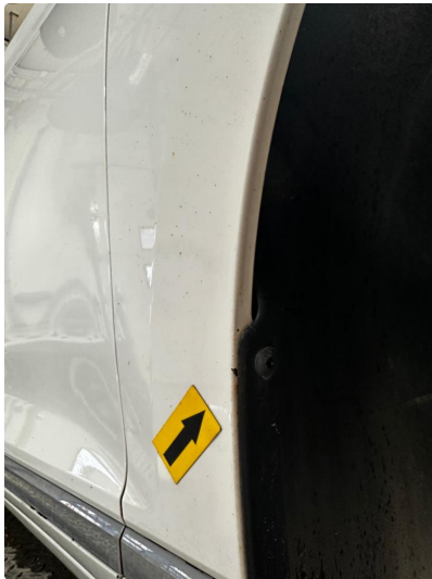
1.3 Steinsprut med rustdannelser i hjulbuen. Normal slitasje
