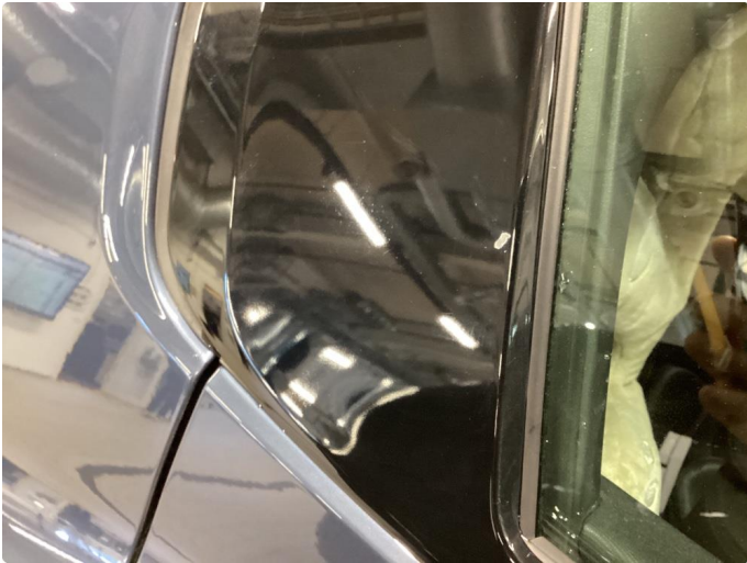
1.1 Stensprut, normal slitasje ihht alder og km
