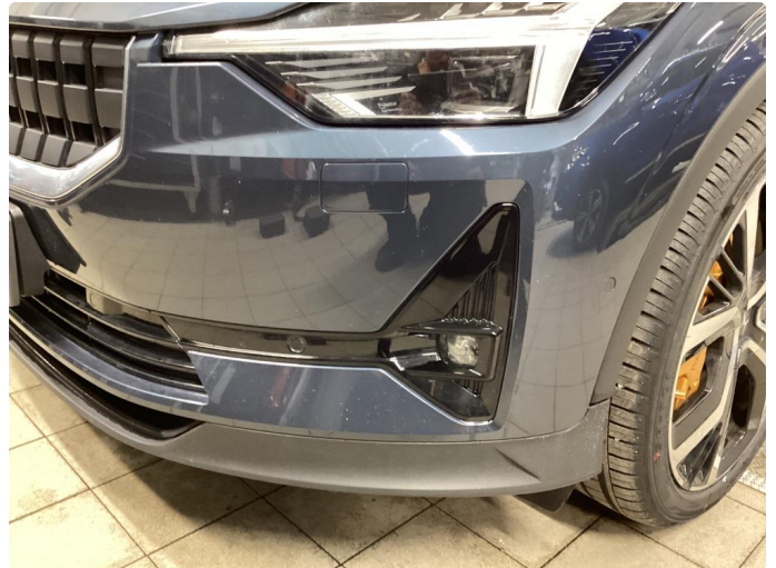
1.1 Stensprut, normal slitasje ihht alder og km
