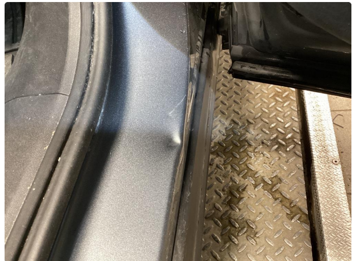
1.3 Bulk med lakkskade, innside dør
