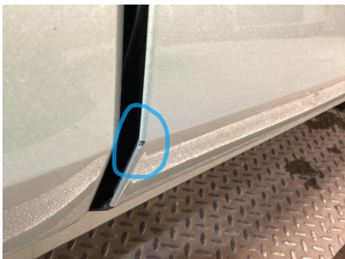
1.3 Steinsprut med rust, fylles i
