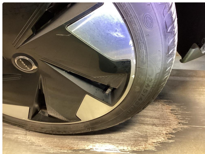
1.2 Kantkjørt felg normalt ihht alder og km
