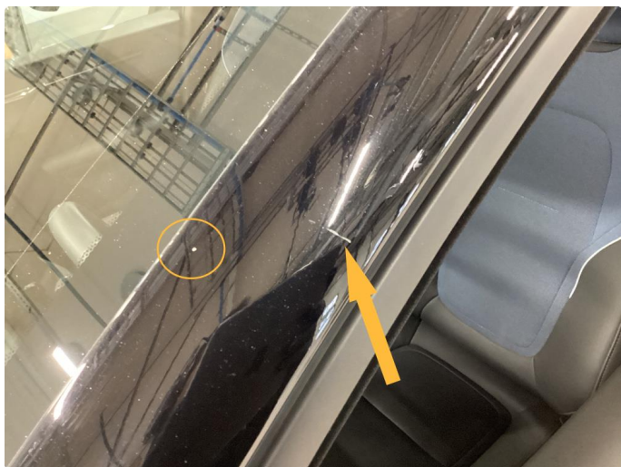
1.4 Ripe ned til grunning
