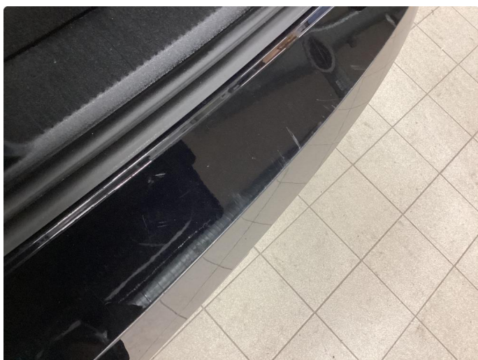
1.2 Ripe(r) ned til grunning
