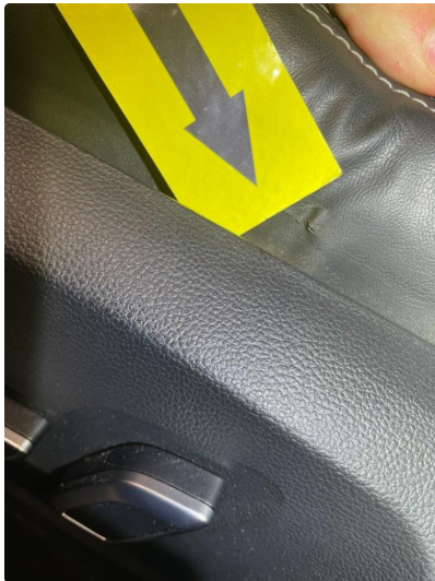
4.3 Skade på setetrekk
