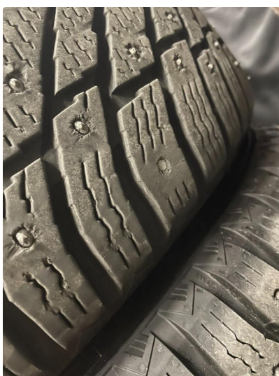
1.9 Piggdekk mangler pigger
