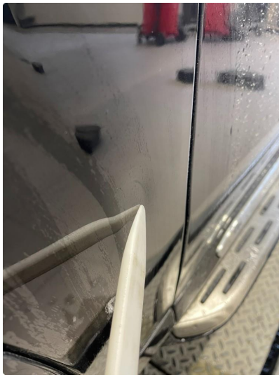
2.5 Bulk med lakkskade Ordnet
