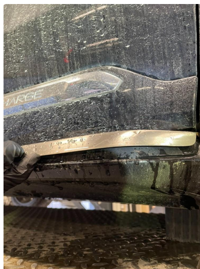
2.11 Steinsprut/sprekk (ordnes forsikrings sak )
