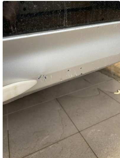
2.9 Skade små skapeskader underside
