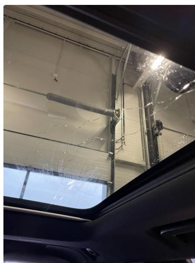
2.11 Steinsprut/sprekk (ordnes forsikrings sak )
