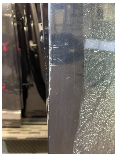
2.3 Skade ordnes med lakkstift
