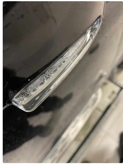
2.6 Blinklys defekt/fukt ( byttes garanti )
