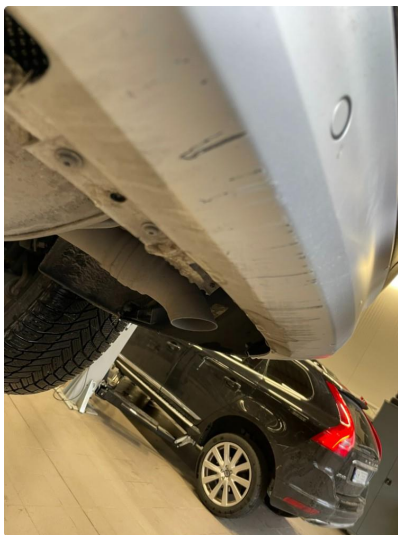
2.9 Skade små skapeskader underside
