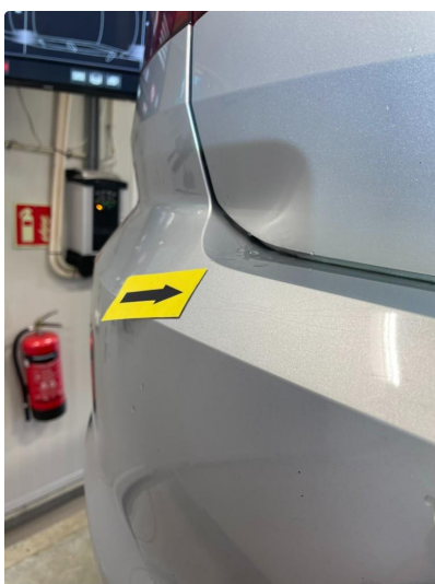
1.4 Skade ( ripe i lakk ordnes med lakkstift )
