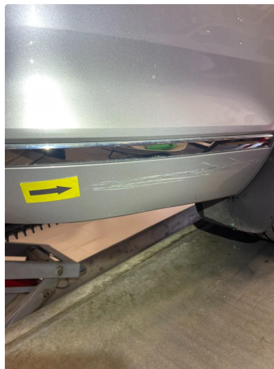
1.4 Skade ( ripe i lakk ordnes med lakkstift )
