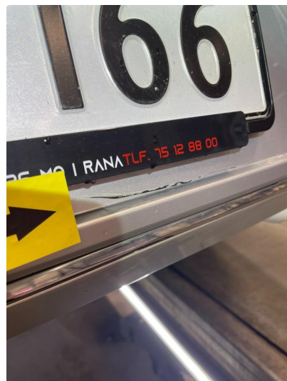
1.4 Skade ( ripe i lakk ordnes med lakkstift )
