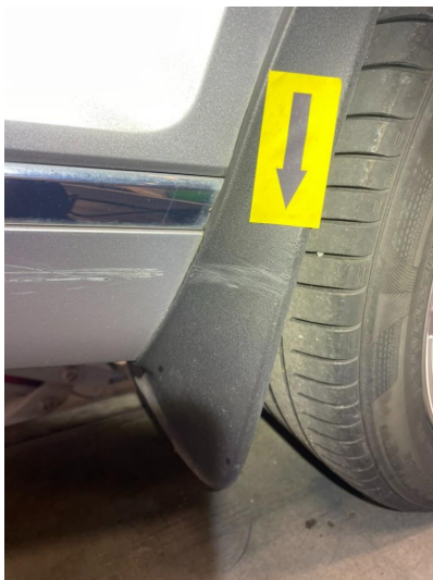
1.4 Skade ( ripe i lakk ordnes med lakkstift )
