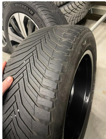
1.6 Skjev slitasje på sommerdekk
