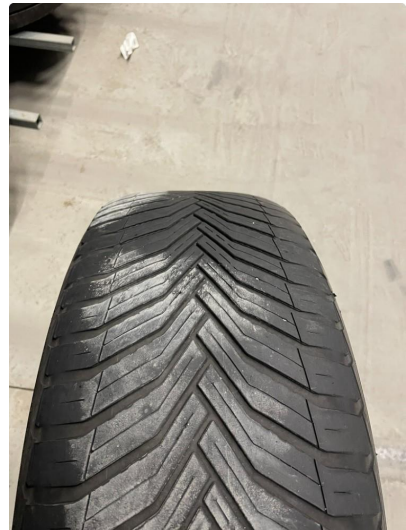
1.6 Skjev slitasje på sommerdekk
