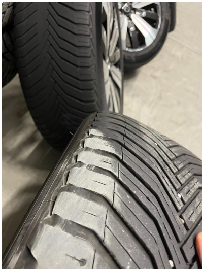
1.6 Skjev slitasje på sommerdekk
