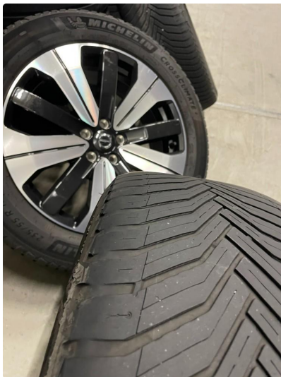
1.6 Skjev slitasje på sommerdekk
