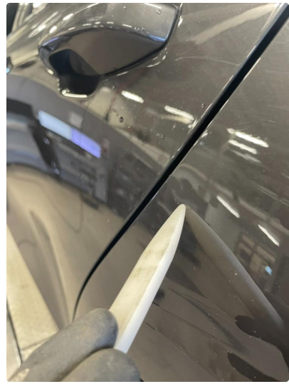
1.2 Bulk med lakkskade ( ordnes )
