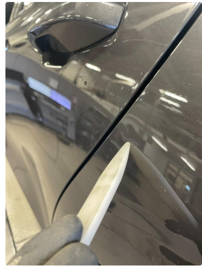
1.2 Bulk med lakkskade ( ordnes )
