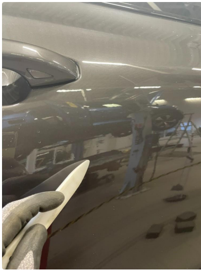
1.2 Bulk med lakkskade ( ordnes )
