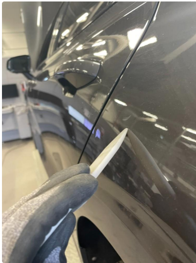
1.2 Bulk med lakkskade ( ordnes )
