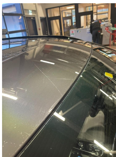
1.1 Generelt mye bruksslitasje
