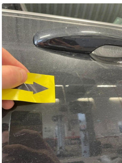
1.2 Flere p-bulker ( rettes ut og poleres over )
