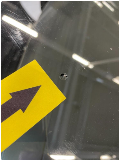
1.8 Steinsprut med sprekk i synsfelt
