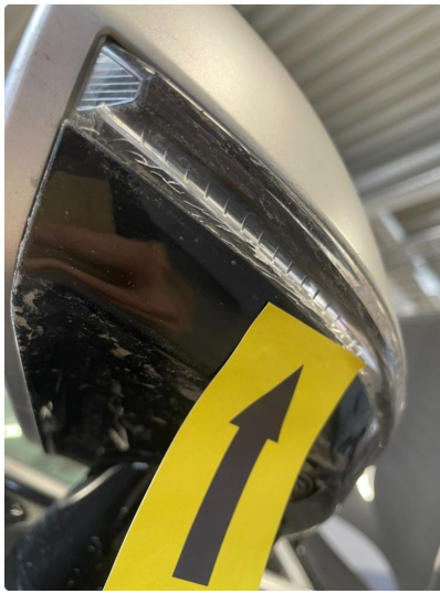
1.4 Blinklys sprukket/krakelert ( ordnes garanti )
