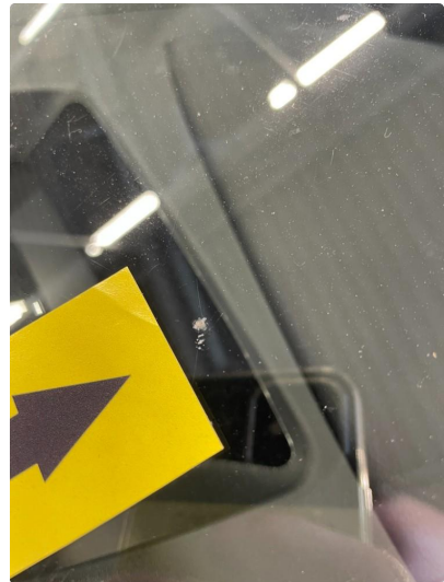
1.8 Steinsprut med sprekk i synsfelt
