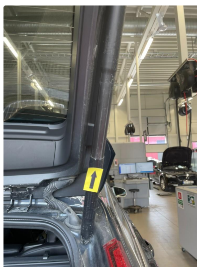
1.3 Dempere defekt ( ordnes før salg )
