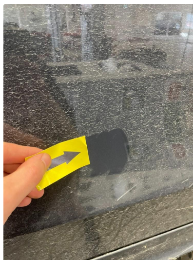
1.2 Flere p-bulker ( rettes ut og poleres over )
