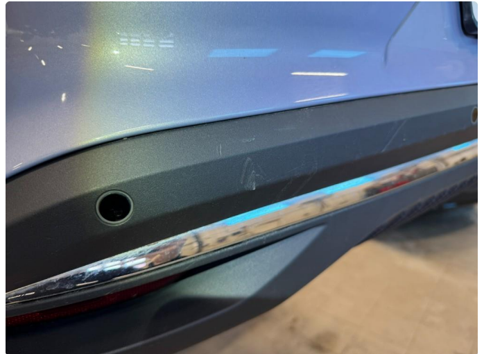
1.2 Skade/ lakkskadene er lagt lakk i
