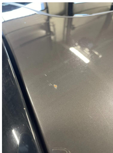
1.10 Rust ( slipes ned og legges i ny lakk ).
