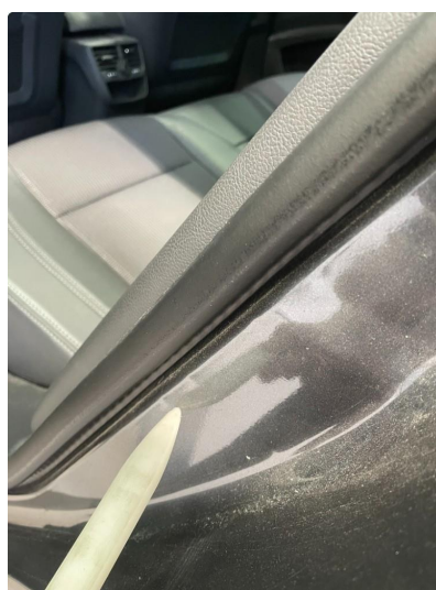
1.3 Bulk(er) med lakkskade
