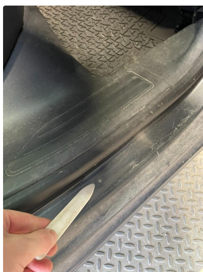
1.3 Bulk(er) med lakkskade
