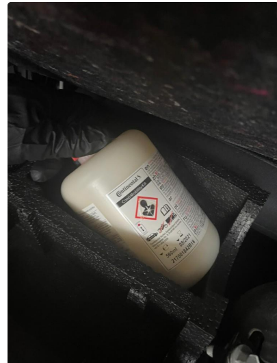
2.2 Dekktettermiddel utgått/mangler ( byttes )
