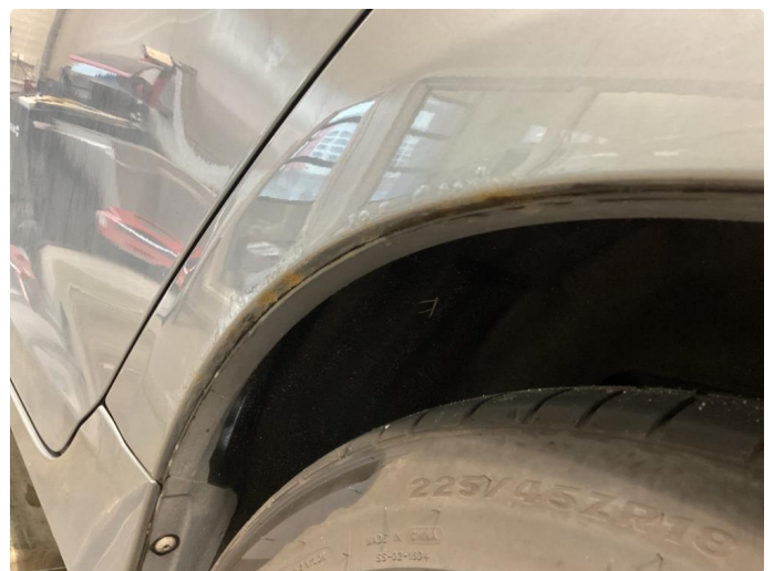
1.2 Noe korrosjon/rust (ordnes med smart repair før utlevering)
