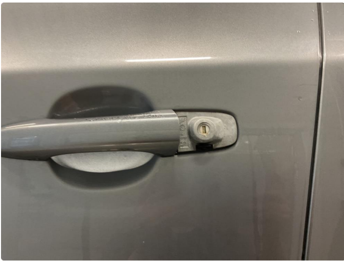
1.3 Øvrige feil (deksel før nød nøkkelåpning bestilt nytt)
