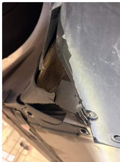
1.1 Beskyttelsesplate skadet/mangler ( ny ordnet og montert )
