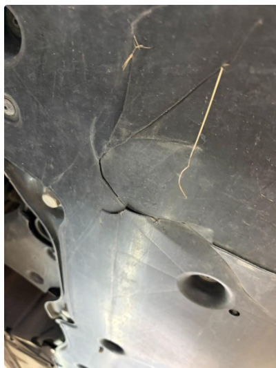
1.1 Beskyttelsesplate skadet/mangler ( ny ordnet og montert )
