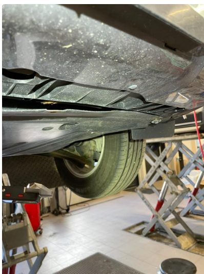
1.2 Beskyttelsesplate skadet/mangler ( mangler skruer, ordne nye )
