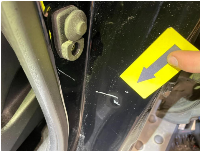
1.7 Bulk med lakkskade ( bruksslitasje )
