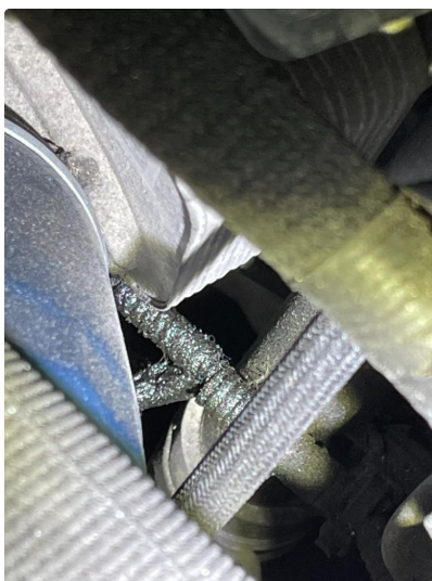
3.2 Oljelekkasje fra motor ( Olje er etter påfylling. motor ok )
