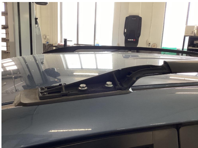
1.4 Deksler på tak/rails mangler
