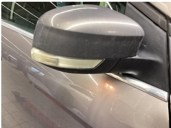
2.3 Krakelering i plast
