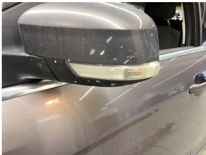
2.3 Krakelering i plast
