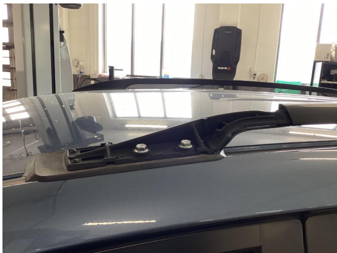
1.4 Deksler på tak/rails mangler
