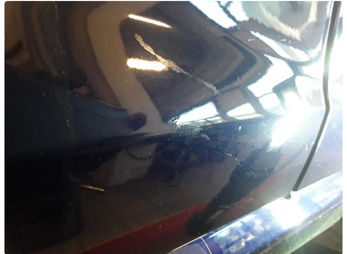
1.3 Steinsprut med korrosjon høyre fordør.
