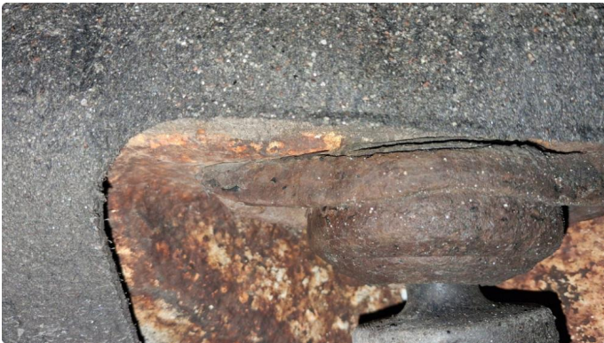
2.1 Rust på innfestning til støtdempere bak.
