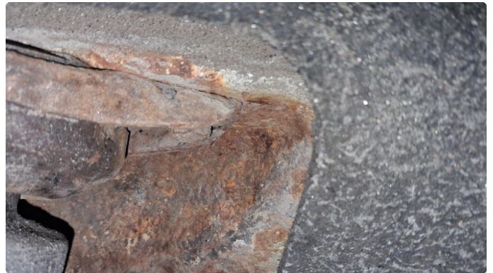
2.1 Rust på innfestning til støtdempere bak.
