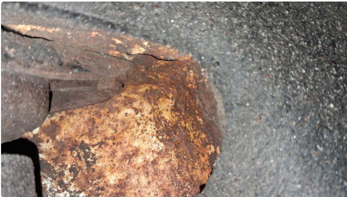
2.1 Rust på innfestning til støtdempere bak.
