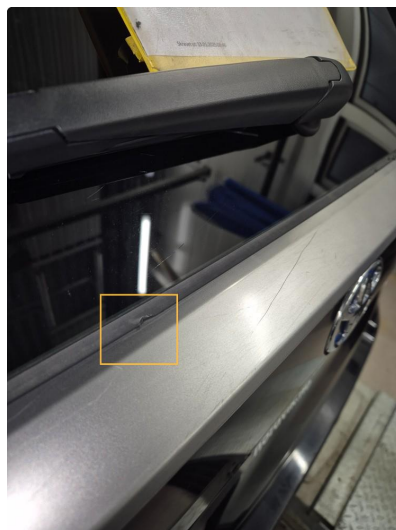
2.1 Skade på pakning, bakrute
