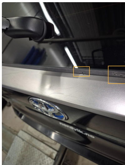
2.1 Skade på pakning, bakrute
