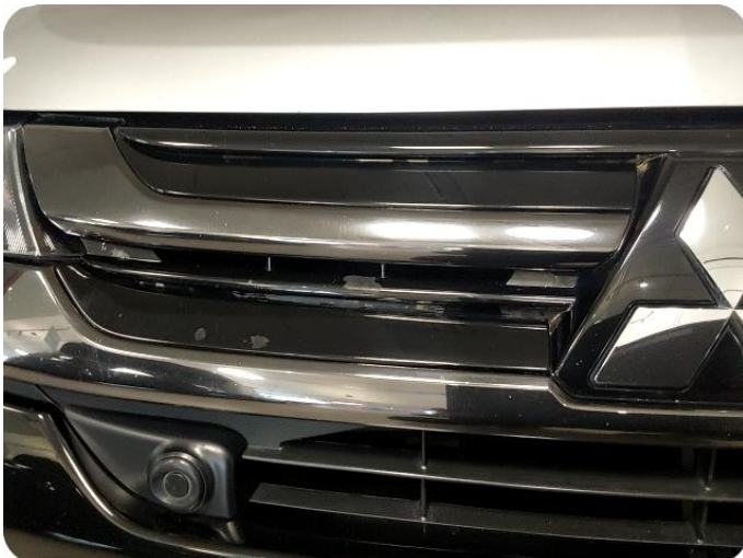
1.2 Lakk flasser Flasser lakk fra grill- normal slitasje
