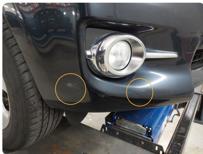
3.9 Ripe(r) ned til grunning
