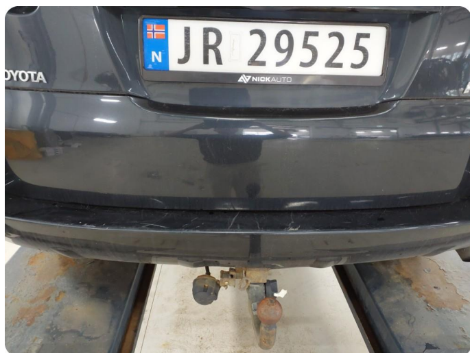
3.8 Ripe(r) ned til grunning
