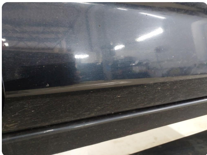
3.4 Ripe ned til grunning
