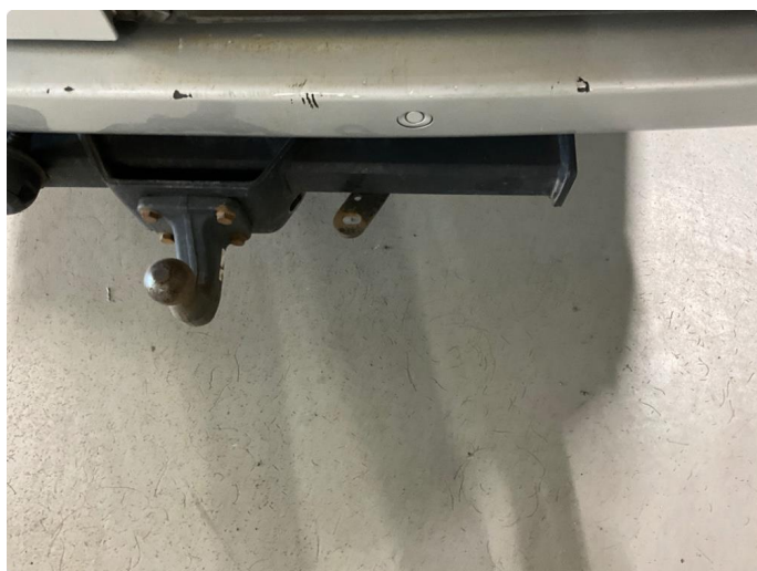
1.8 Ripe(r) ned til grunning
