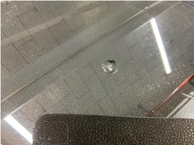
1.1 Steinsprutskade nede h. side frontrute. Denne er reparert.
