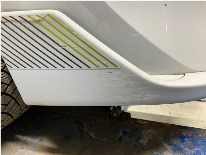
1.2 Ripe(r) ned til grunning
