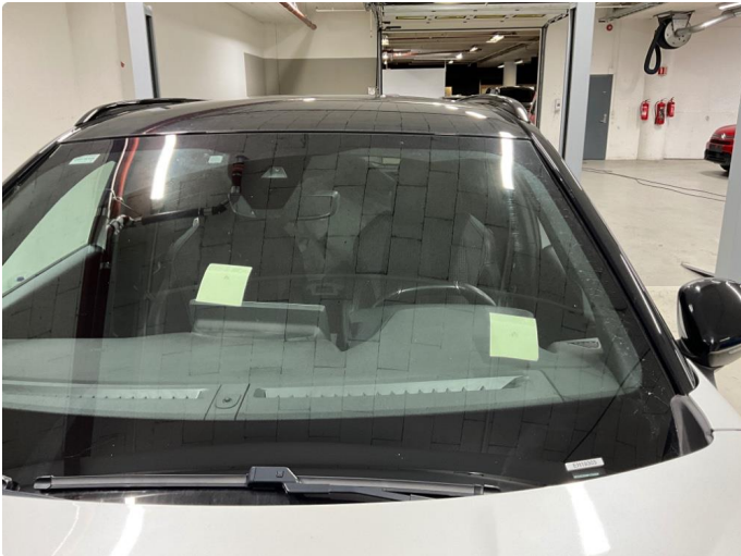
1.1 2 steinsprut skader frontrute. Disse er reparert.
