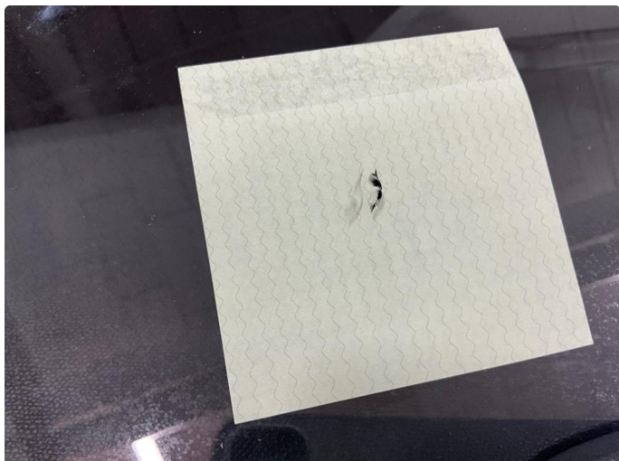
1.1 Mindre steinsprutskade nede h. side frontrute. Denne er reparert.
