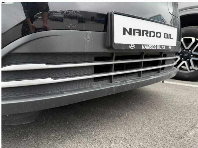
1.3 Riper og små bulker støtfanger foran.
