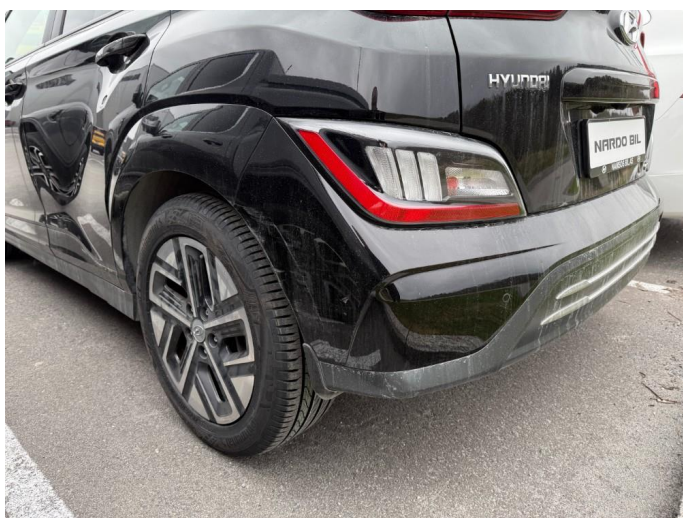
1.4 Riper støtfanger bak.
