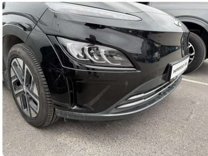
1.3 Riper og små bulker støtfanger foran.
