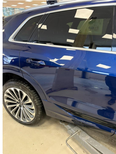
1.1 Liten bulk med lakkskade i dør høyre bak
