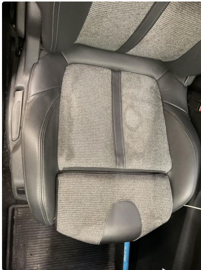
1.1 Skade på setetrekk
