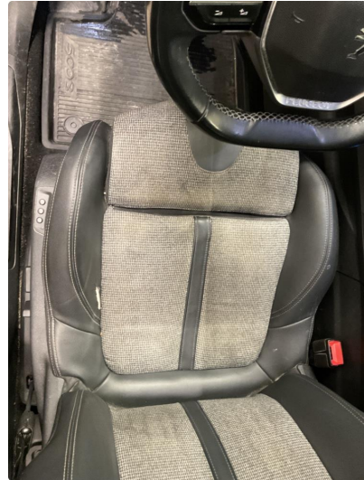
1.1 Skade på setetrekk
