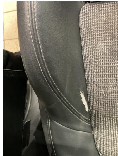
1.1 Skade på setetrekk
