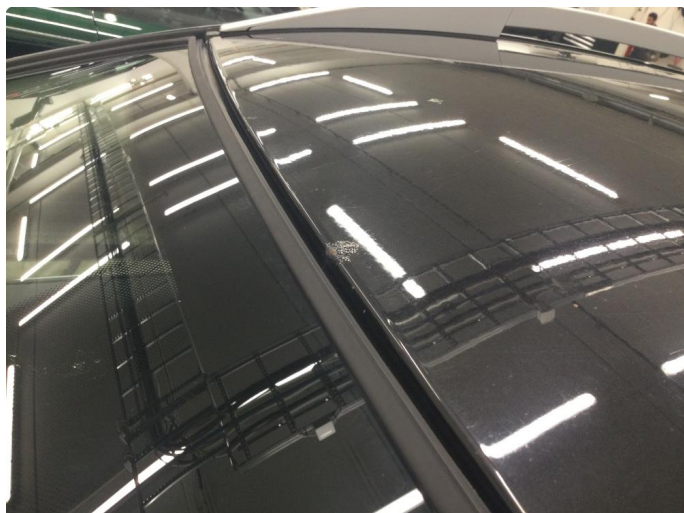
1.11 Steinsprut med rust
