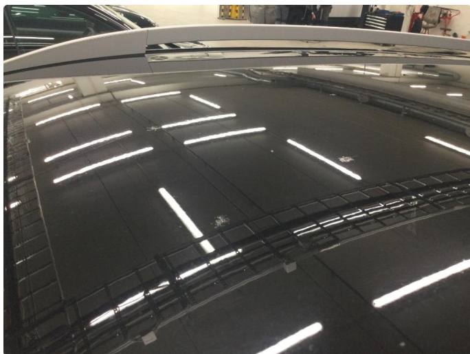
1.11 Steinsprut med rust
