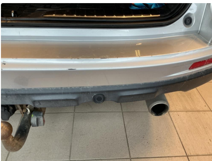
1.3 Ripe(r) ned til grunning
