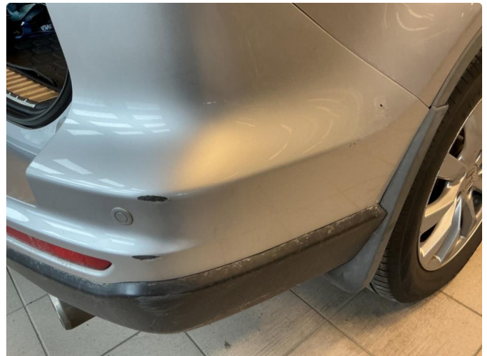
1.3 Ripe(r) ned til grunning
