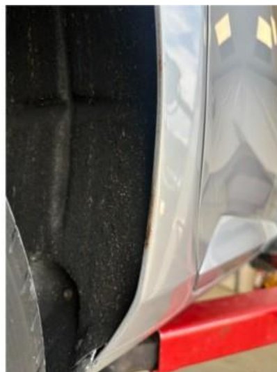
1.3 Litt rustdannelse i hjulbue høyre bak
