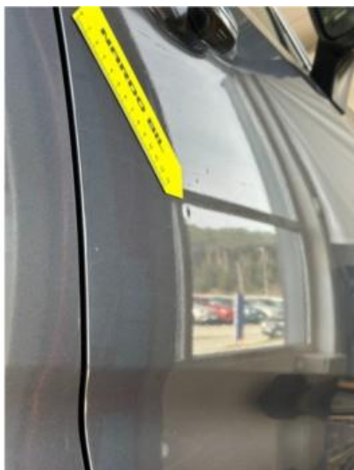
1.1 Ubetydelig bulk i dør høyre foran
