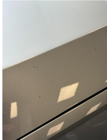
1.1 Noen steinsprut i panser
