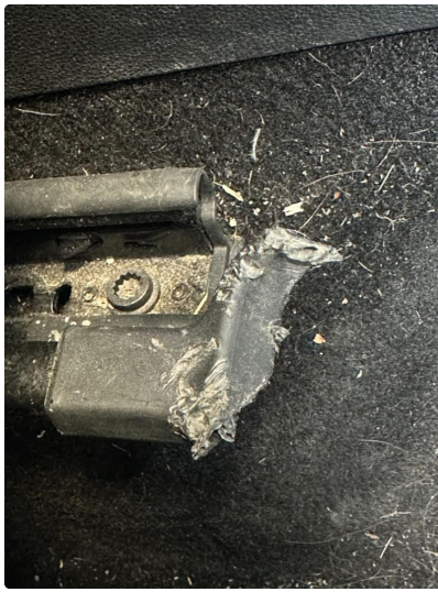
2.1 Liten skade på justeringsskinne sete høyre foran
