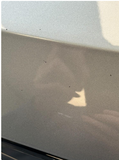
1.1 Noen steinsprut i panser
