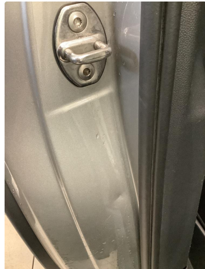
1.4 Liten bulk i døråpning etter sele
